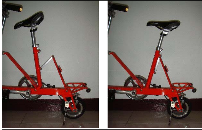
圖 2.3 摺疊式腳踏車 由四邊形的不穩定性至三角形的穩定性
